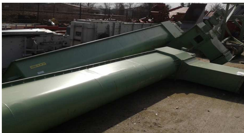
Podajniki ślimakowe przystosowane do zabudowy pod zbiornikiem, jako odbiór materiału
