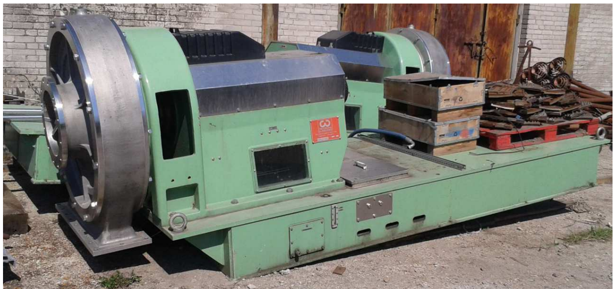
Rysunek 1 Zdjęcie młynów dyskowych AJ101 i AJ102 (bez silników)
