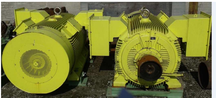
Rysunek 3 Silniki młynów
