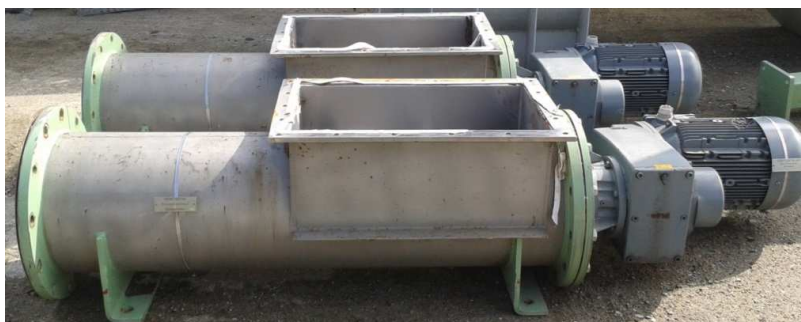
Rysunek 2 Zdjęcie podajników ślimakowych dozujących AF103 i AF104
